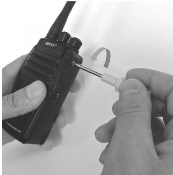
Рис. 8. Снятие защитной крышки аксессуарного соединителя.
