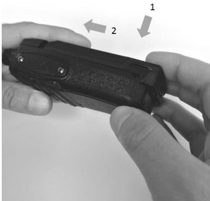
Рис. 2. Установка аккумуляторной батареи.
