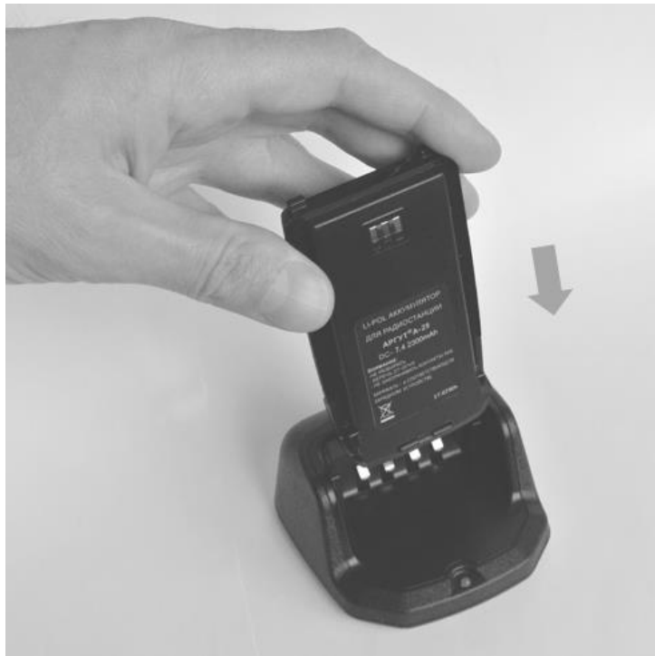
Рис. 7. Установка аккумуляторной батареи на зарядную базу.
