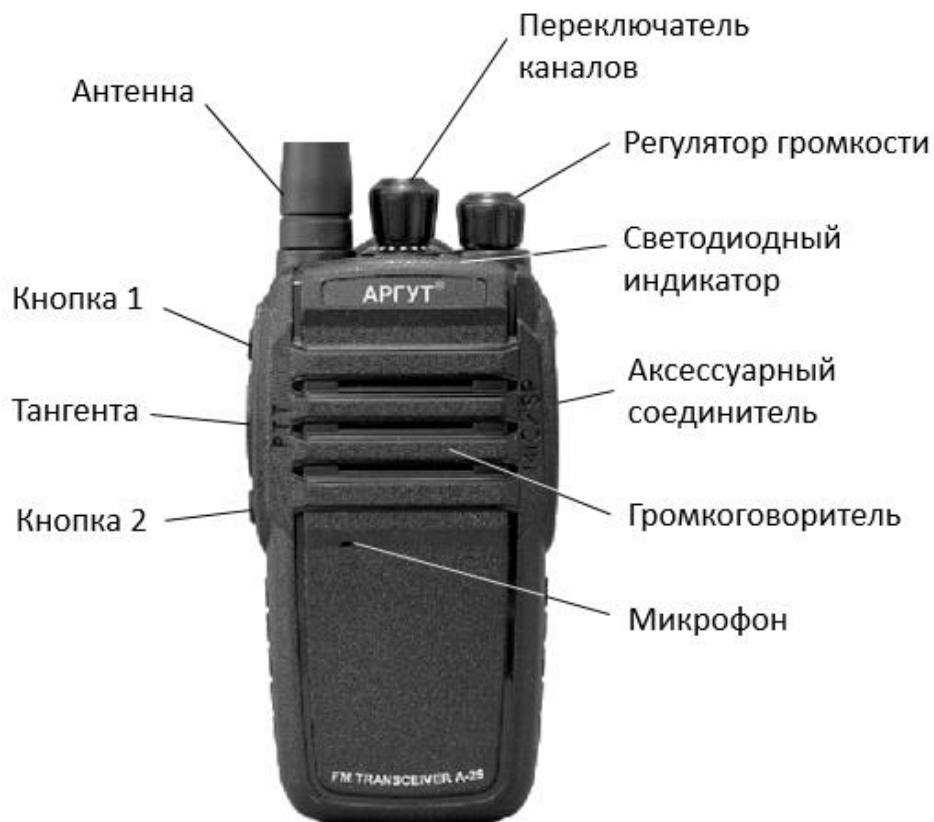
Рис. 1. Расположение органов управления, индикации и соединителей.
