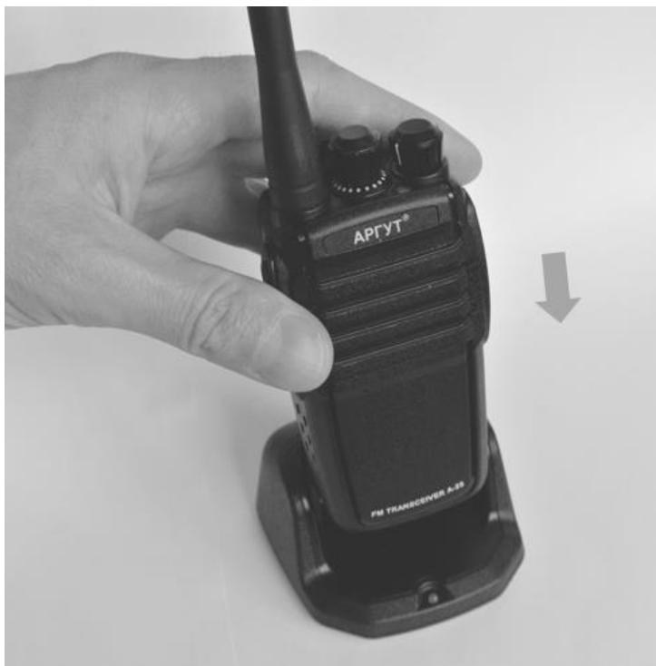
Рис. 6. Установка радиостанции на зарядную базу.
