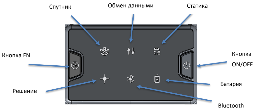
Рисунок 1.6 Кнопки и индикация Oscar Basic
