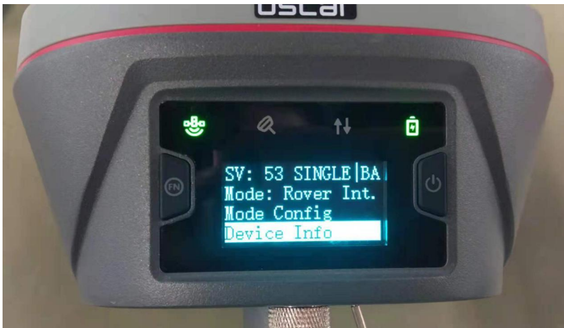
Рисунок 2.27 Светодиодная панель отображает интерфейс управления
