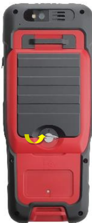
Рисунок 2.36 Снятие задней крышки
