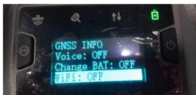
Рисунок 2.21 Интерфейс Wi-Fi (версии Advanced и Ultimate, Trek)
