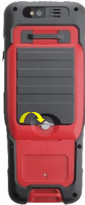
Рисунок 2.40 Вставка задней крышки
