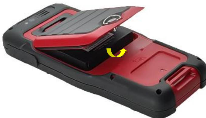
Рисунок 2.37 Снятие задней крышки
