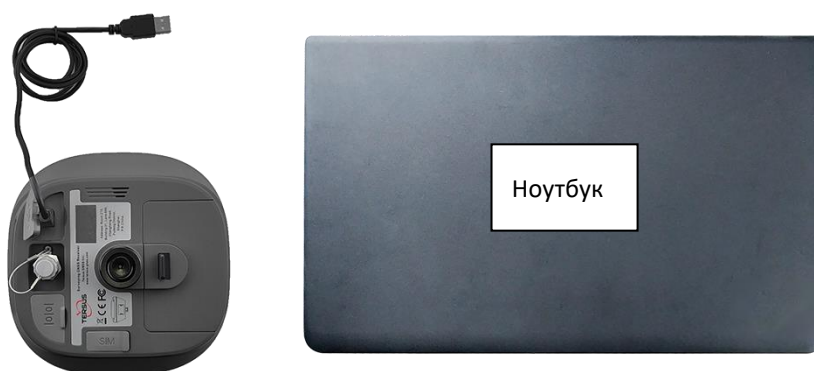
Рисунок 2.16 Подключение приемника к компьютеру
