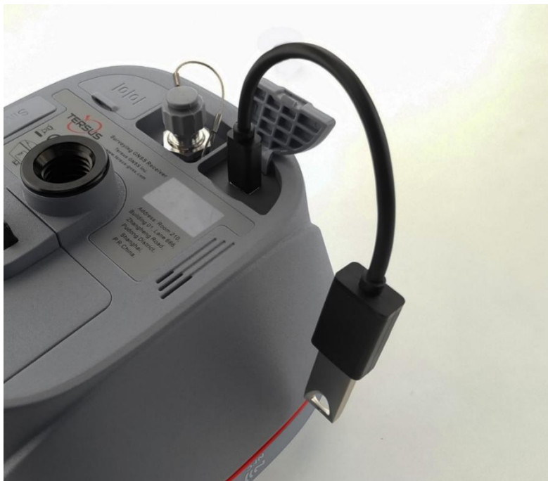
Рисунок 2.26 Подключение приемника к USB-накопителю через OTG кабель
