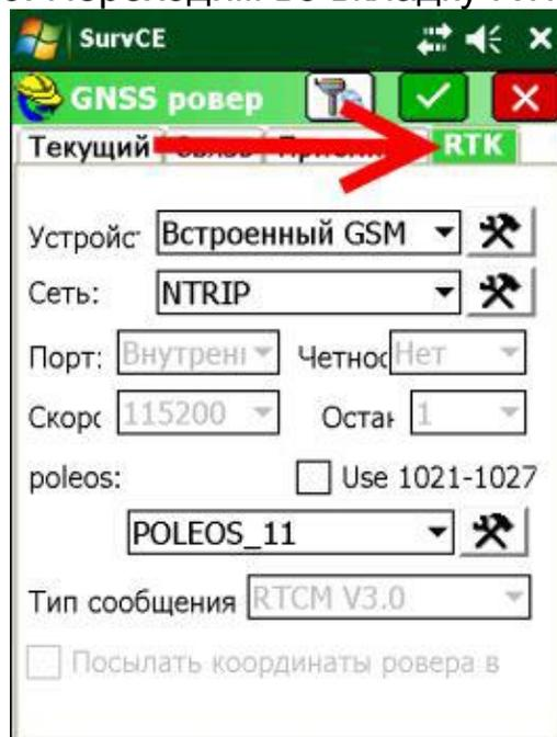
7. Нажимаем на значок «инструменты», рядом с сетью NTRIP:
